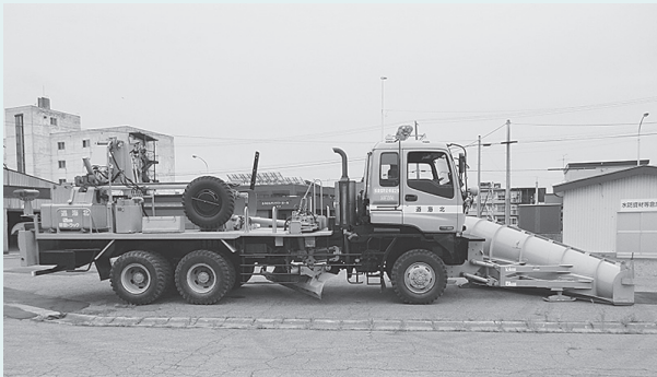
今冬の除雪作業から使用する除雪トラック
