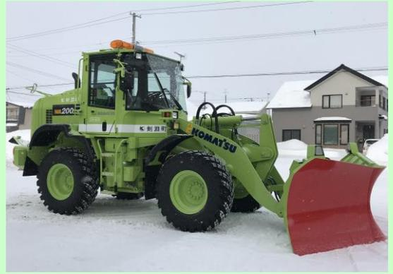
1月30日、除雪ドーザーが納品されました。11t級車輪式+81Kw、マルチプラウ・簡易着脱装置付きで、16,686,000円で購入しました。そのうち、社会資本整備総合交付金として7,314,000円が交付されています。
